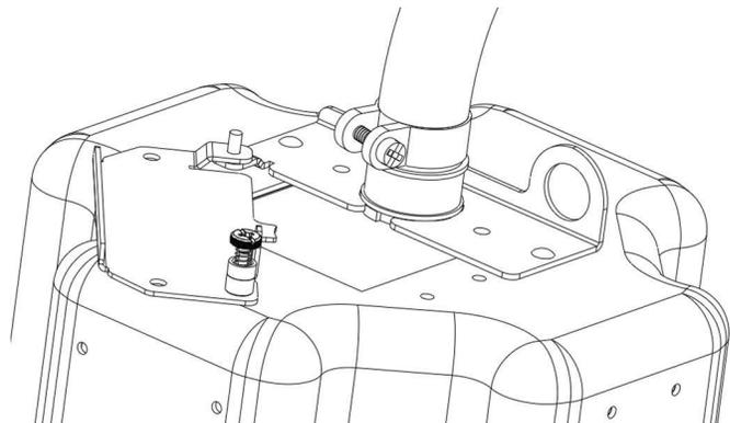
Figure 13: Clamping a conduit
