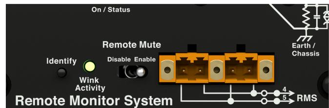
Figure 32: 750-LFC RMS Module
